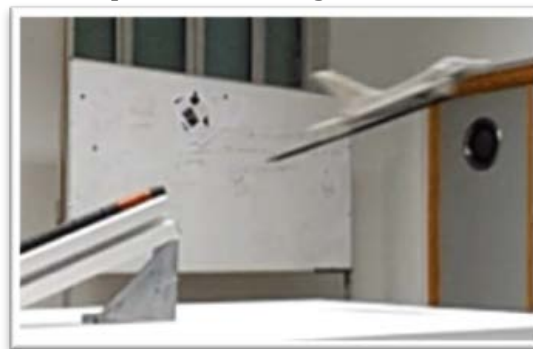
Figura 1. Izquierda: maqueta de Eurofighter Typhoon utilizado en el demostrador. Derecha: demostrador de sistema de aceleración electromagnético en funcionamiento.
