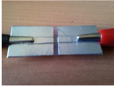
Figura 2. Forma correcta de conectar la película de grafito.
